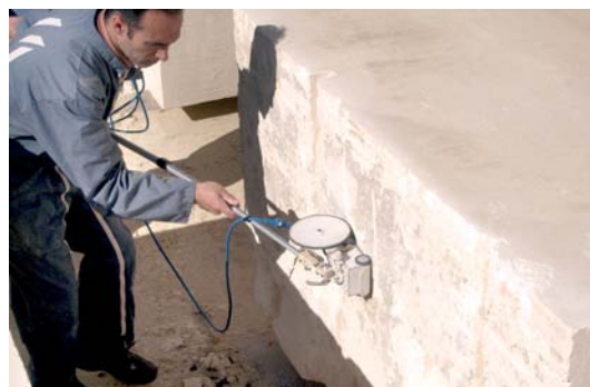
Auscultation radar en cours de réalisation sur un bloc de pierre de Fontvieille, par un technicien du L.E.R.M.
